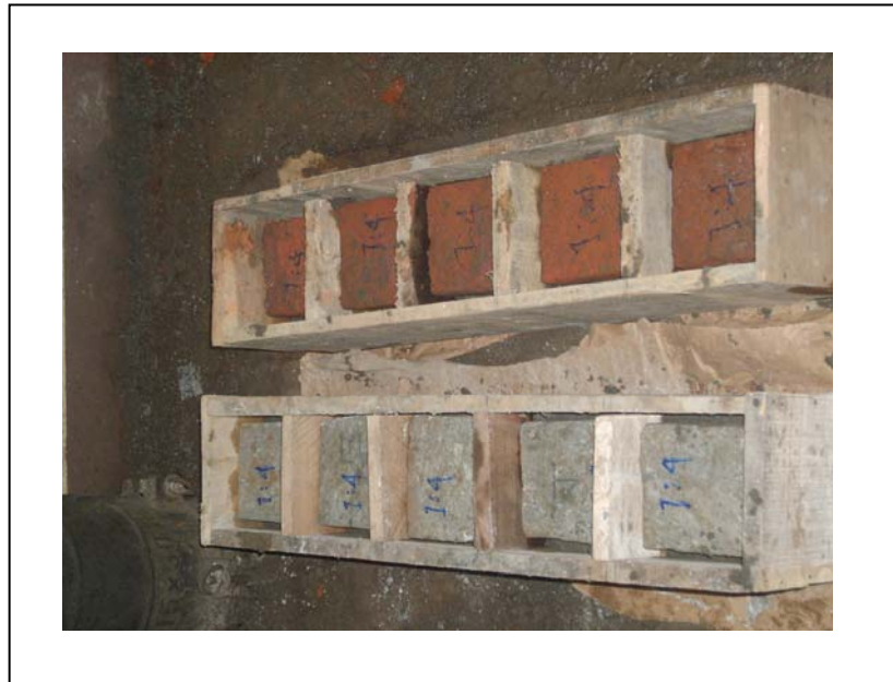
Gambar 4.5. Pembuatan benda uji dengan cetakan dari kayu
