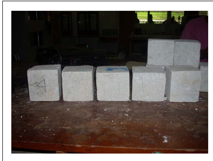
Gambar 4.3. Benda uji setelah diuji kuat tekan
