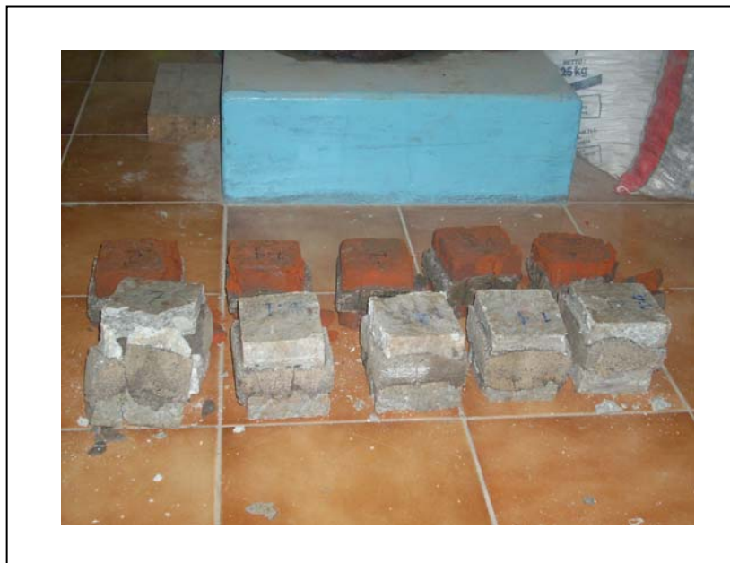
Gambar 4.6. Benda uji berbentuk bata merah pejal setelah diuji kuat tekan
