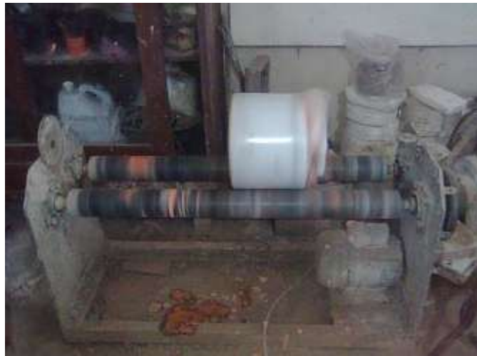
Gambar 4. Proses penggilingan tanah liat.
