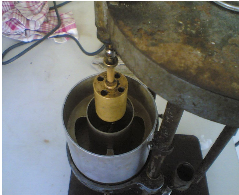
Gambar III.2. Stormer Viscosimeter (dilihat dari atas)
