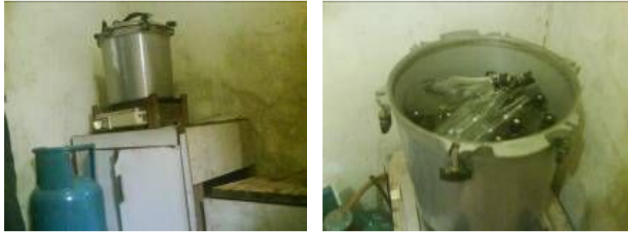
Gambar 8. Sterilisasi alat dan media dengan autoklaf.
