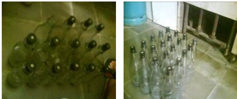
Gambar 6. Botol yang berisi media siap disterilkan dengan autoklaf.
