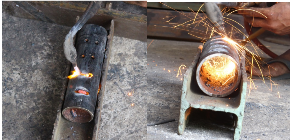
Gambar 4.3 Proses cutting untuk dudukan pisau pemukul
