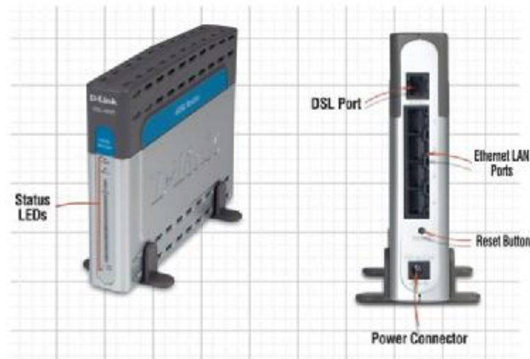
Gambar 4.2. Konfigurasi modem D-LINK DSL-520T
