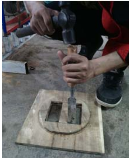
Gambar 4.8 Pembuatan dudukan termoelektrik
