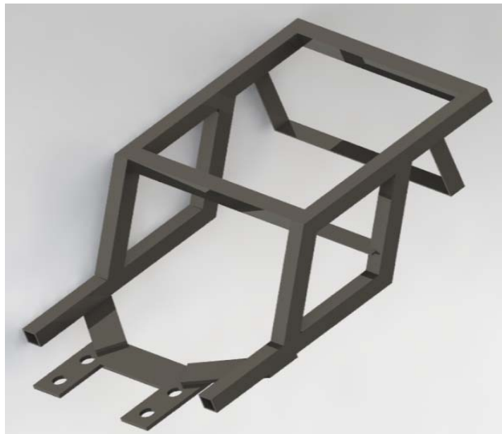
Gambar 4.1. Desain rangka cool box .
