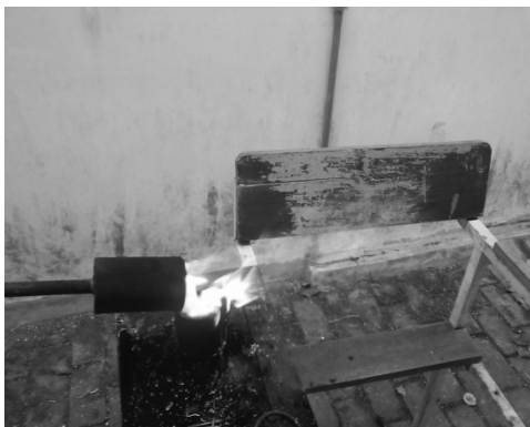
Gambar 3. Lidah Api yang Terbentuk pada Pembakaran Gas Produser
