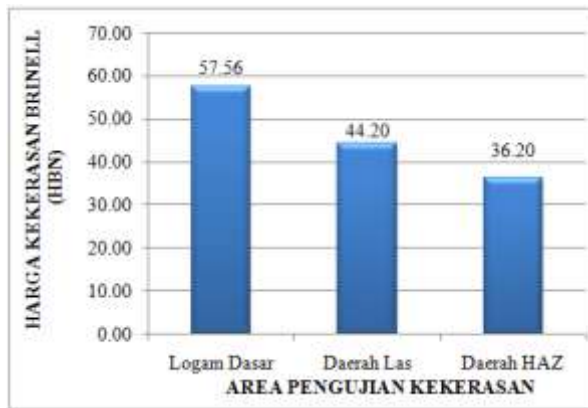
Gambar 17. Histogram Nilai Rata-rata Hasil Uji Kekerasan Brinell
