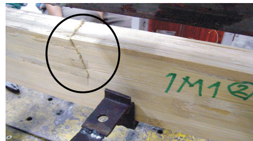
Gambar 4. Pola kerusakan balok pada sisi atas, di tengah bentang balok
